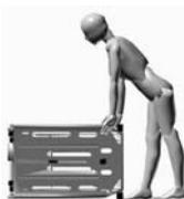
Posizionare il FRACK su di un piano sicuro e livellato, appoggiandolo al terreno, ancora in posizione chiusa, sul lato più lungo.
