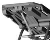
Trovare la posizione desiderata, rilasciare la leva, verificando che il perno di sicurezza si sia inserito correttamente nel foro ad esso riservato, presente sul tubo telescopico.
