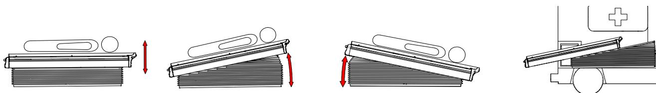
Supports de brancard destinés à être installés sur des ambulances. L'appareil peut prendre plusieurs positions facilitant le chargement et le déchargement de la brancard.
