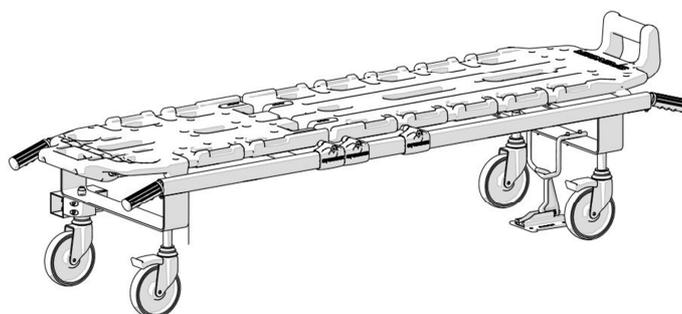
Le barelle da campo TGS della serie PRIME sono dispositivi per il sollevamento e trasporto eseguito da persone, da utilizzarsi in condizioni di soccorso da campo. Lo stazionamento è consentito utilizzando preferibilmente i fermi di stazionamento installati in aree predisposte all'interno dell'area di soccorso.
